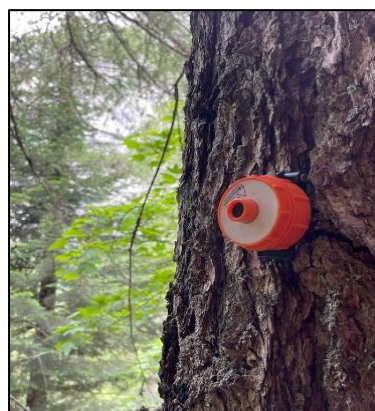
Figura 3. Dall'alto: cavallettamento per il rilievo dei diametri; misura dell'altezza con ipsometro Vertex; applicazione del transponder Vertex per il rilievo dell'altezza.
